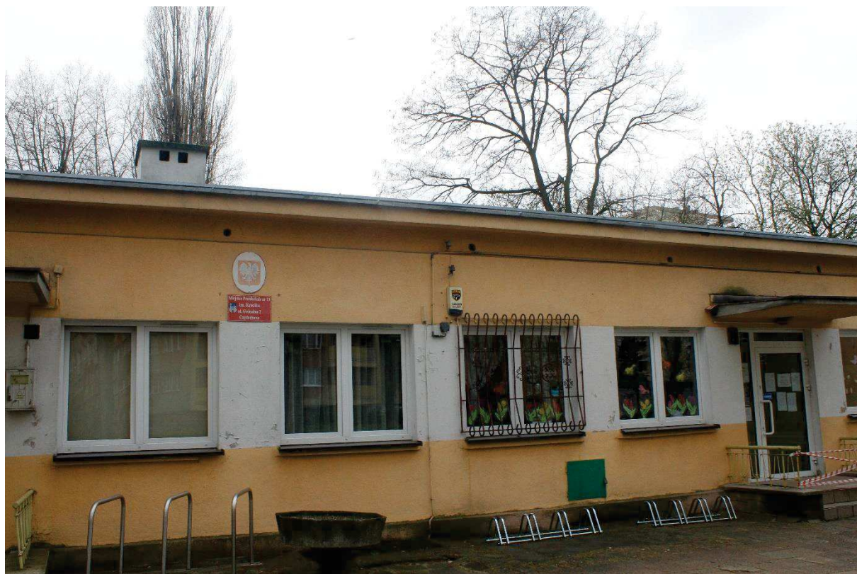
Fot. 4. Częstochowa, ul. Gwiazdna 2, budynek Miejskiego Przedszkola nr 13 – fragment elewacji północnej segmentu A. Widoczne otwory wentylacyjne do stropodachu - zabezpieczone (fot. z dn. 15.04.2022 - S. Czyż)
