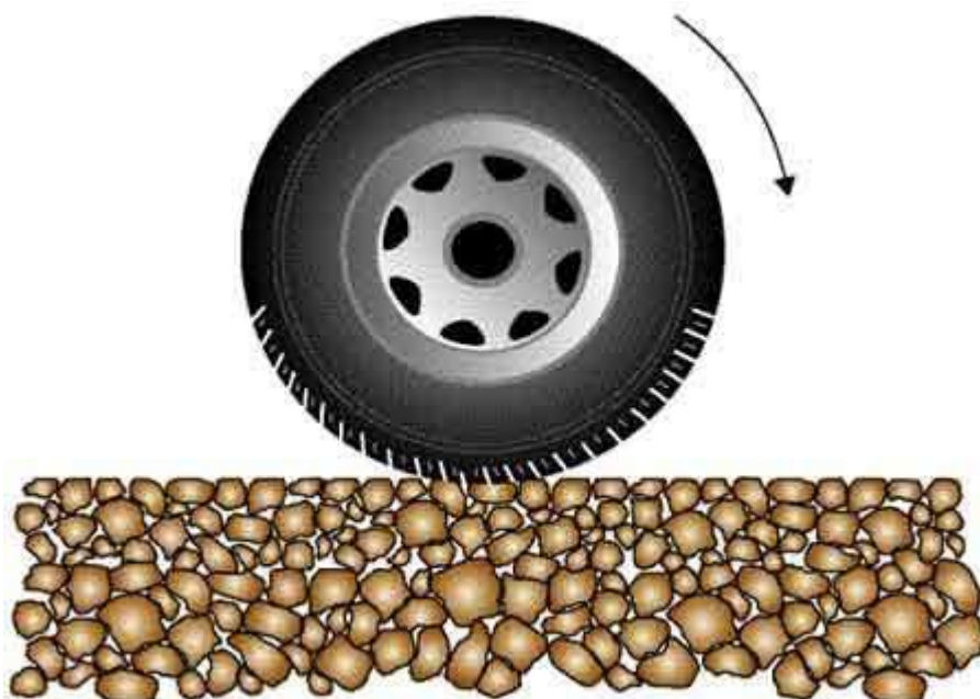
Rysunek 6-4 Asfalt porowaty o dużej zawartości próżni
