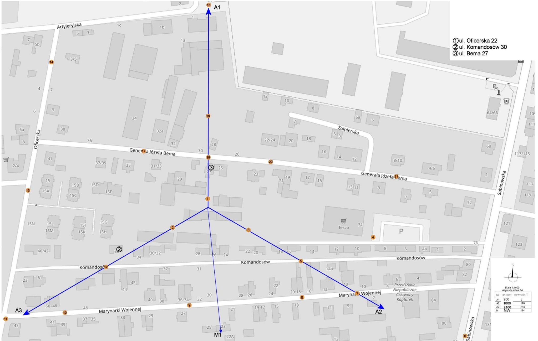
Zat. nr 2: Lokalizacja anten oraz ich azymuty, lokalizacja pionów (punktów pomiarowych) wokół instalacji radiokomunikacyjnej. -punkt (pion) ● pomiarowy.
