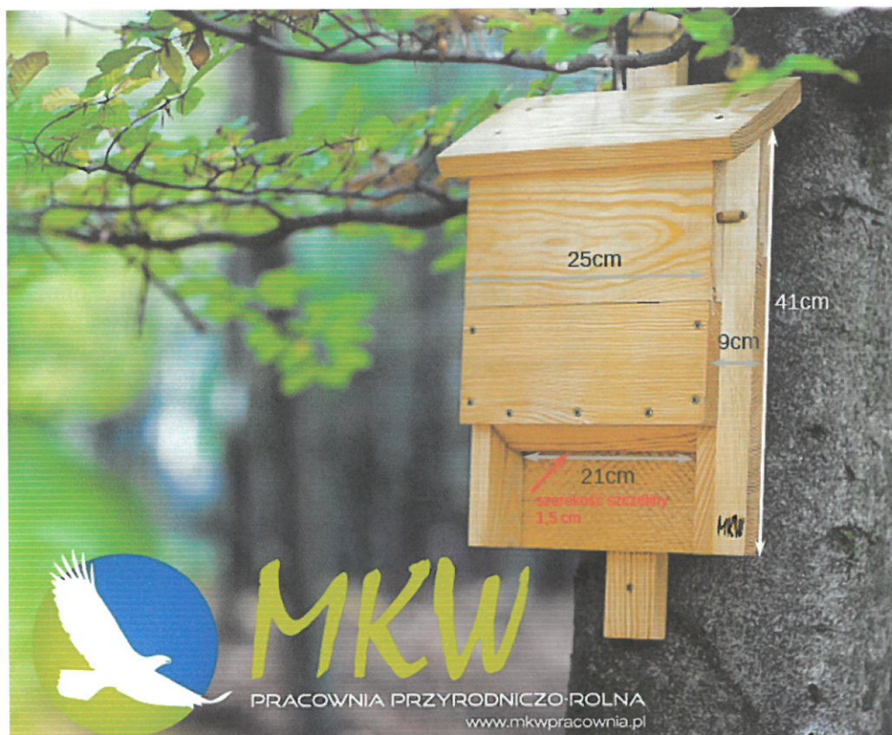
Ryc. 3. Wygląd oraz wymiary schronienia nadrzewnego dla nietoperzy
